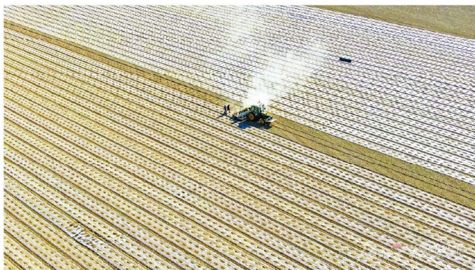
图6-2 装有北斗导航系统的无人驾驶播种机正在播种棉花
